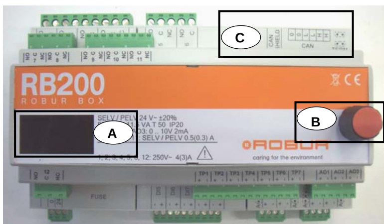
Figure 28 Dispositif RB200 complet. La figure montre l'écran, l'encodeur et le port CAN-BUS.
