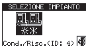
Figura 1.23 Menu installazione impianti: selezione impianto
