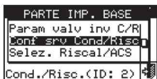
Figura 1.57 Menu impianto base - configurazione servizi condizionamento/riscaldamento
