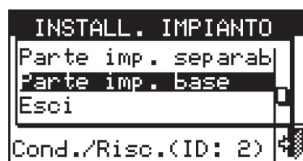
Figura 1.151 Menu Installazione impianti: impianto base
