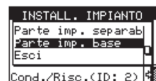
Figura 1.161 Menu Installazione impianti: impianto base
